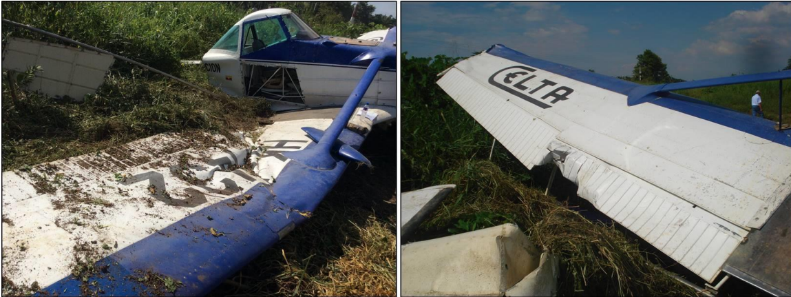
Daños estructurales en el plano derecho (Izq.) y plano izquierdo (Der.)
