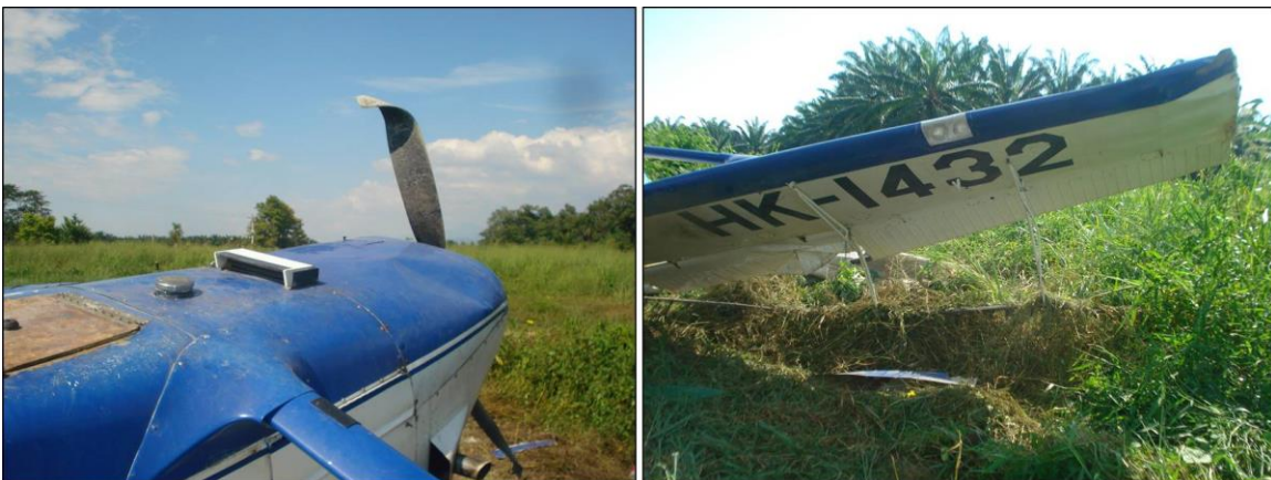
Daños en las puntas de las palas de la hélice (Izq.) y sistema de aspersión (Der.)
