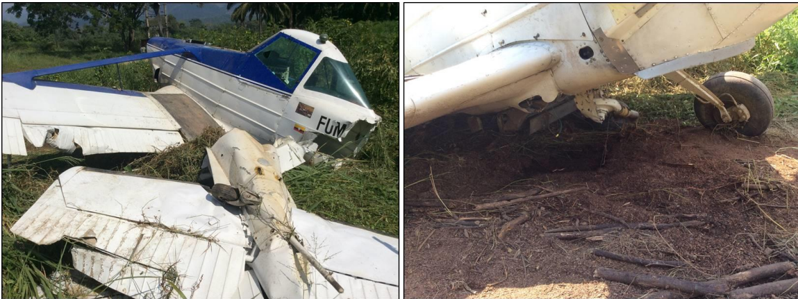
Fractura y separación del cono de cola (Izq.) y fractura y separación del tren de aterrizaje derecho (Der.)
